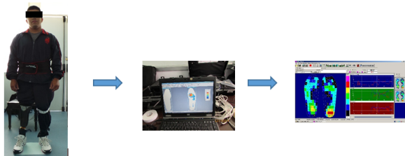
Figura 3. Configuración del sistema para realizar las mediciones de presión plantar en persona amputadas y no amputadas.
