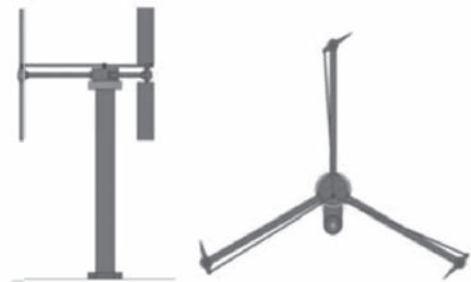
Figura. 1. Vista lateral y superior de una turbina Giromill
