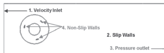
Figura 6. Condiciones de frontera para la simulación
