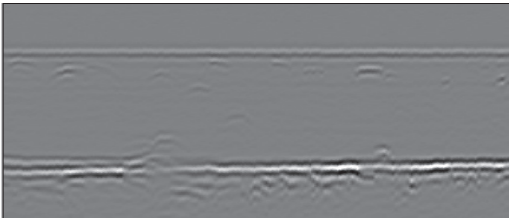
Figura 7. Imagen D-Scan libre de distorsión. Obsérvese que ahora la imagen producida por la onda lateral constituye una línea de referencia idónea para determinar con precisión la posición de los defectos
