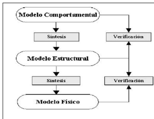
etapas de verificación entre los diferentes niveles de abstracción, que permiten validar violaciones a reglas de diseño, tanto en funcionalidad como en temporalidad, como en geometría. El esquema general de dicho proceso se muestra en el diagrama 2.
