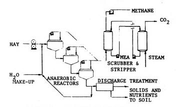
FIGURE 3. ANAEROBIC METHANE PROCESS
