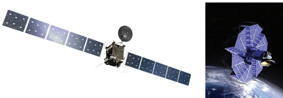
Figura 6 – Painéis fotovoltaicos em satélites
