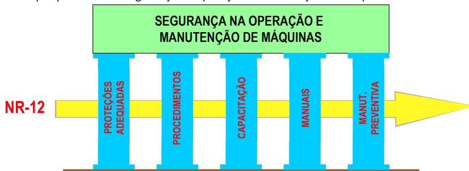
Figura 2 – Etapas para realizar segurança na operação e manutenção de máquinas de acordo com a NR 12
