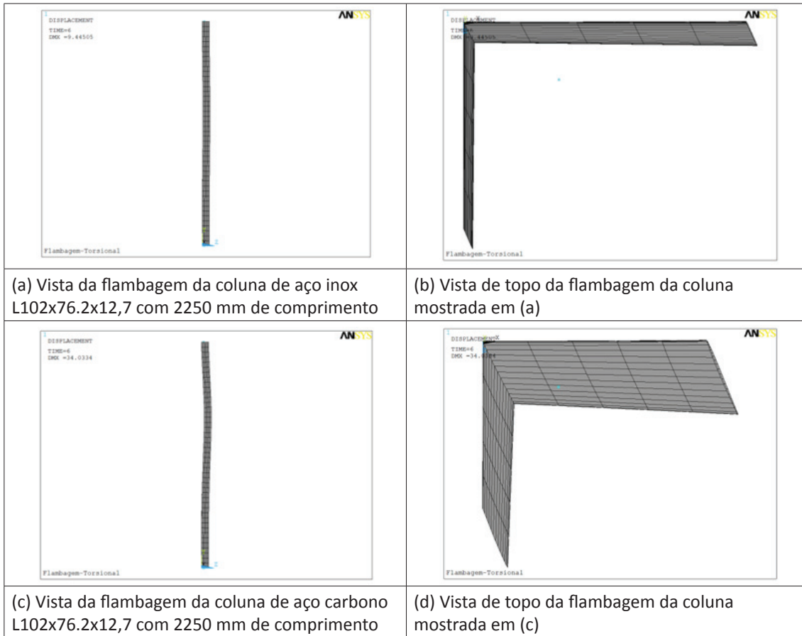
Figura 6: Modos de flambagem de cantoneiras de abas desiguais
