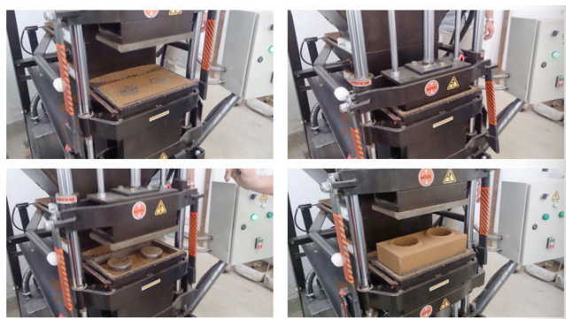
Figura 5 - Sequência de confecção do tijolo na Prensa Hidráulica.
