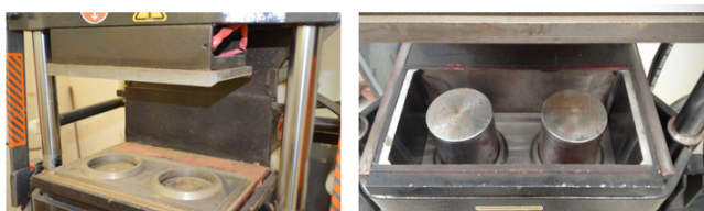
Figura 4 - Prensa hidráulica ECO PREMIUM modelo 2700 com matriz metálica aquecida.
