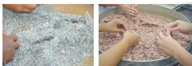
Figura 2 - Preparação prévia das cédulas trituradas, fragmentadas e compactadas.
