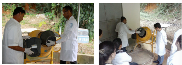
Figura 3 - Sequência de homogeneização da mistura com 12% de umidade.
