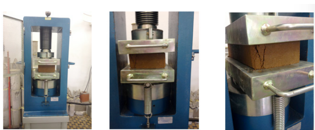
Figura 8 - Ensaio de Compressão e apresentação de fissuras nos tijolos após rompimento.
