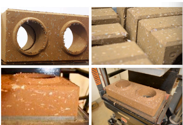
Figura 9 - Forma final do Tijolo fabricado com cédulas de dinheiro.
