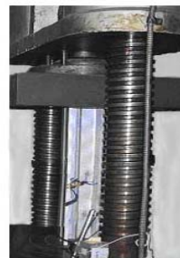
Fig. 5 Local buckling of stud column
