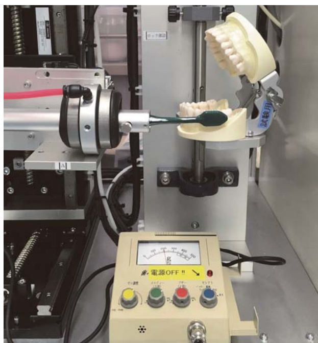
図2 ブラッシングマシンによる各被験歯ブラシのブラッシング時における毛先の歯間部への到達試験
