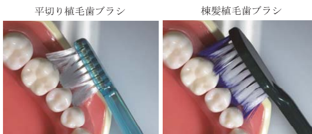
図10 各被験歯ブラシのブラッシング時における毛先の歯間部への到達状況
