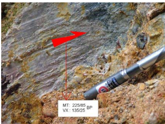
Ảnh 1. Mặt trượt và vết xước kiến tạo (trượt bằng phải) trong vỏ phong hóa của trầm tích Neogen (Khu vực cầu Yên Bái)
