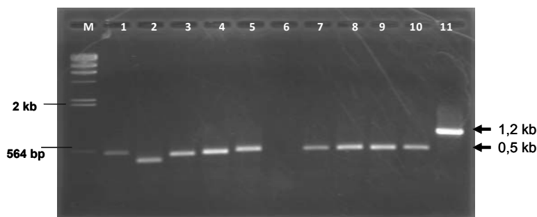
Hình 1. Ảnh điện di một số sản phẩm PCR vùng gen ITS thu được từ các mẫu nấm đại diện (mẫu 1-11). M: Chỉ thị DNA (Lambda cắt bằng Hind III); mũi tên chỉ kích thước sản phẩm PCR thu được (trong khoảng 0,5 kb đến 1,2 kb). Mẫu: 1: 200361; 2: 201655; 3: 206345; 4: 206573; 5: 215344; 6: 218232; 7: 231340; 8: 227677; 9: 234937; 10: 238162; 11: 243888 (kí hiệu mẫu, xem Bảng 1 ).
