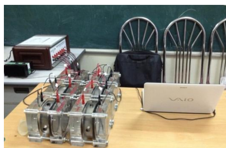
Hình 1: Thí nghiệm xác định độ thẩm thấu ion clo bằng phương pháp đo điện lượng
