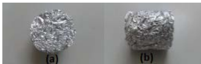
Fig. 3. Probetas cilíndricas de aluminio plexoplegado para ensayo cuasiestático de compresión a) vista transversal b) vista longitudinal.
