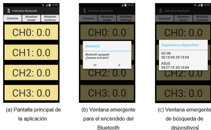
Figura 12 Configuración de la conexión Bluetooth entre el voltmetro y el teléfono inteligente.
