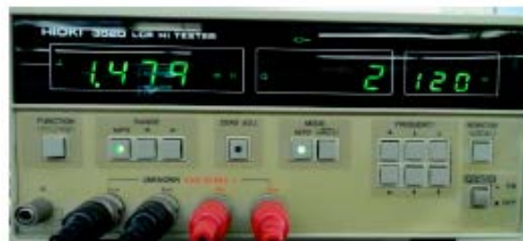
Figura 12 Medición en puente automático LCR; inductor 1.4 mH a 5 A.
