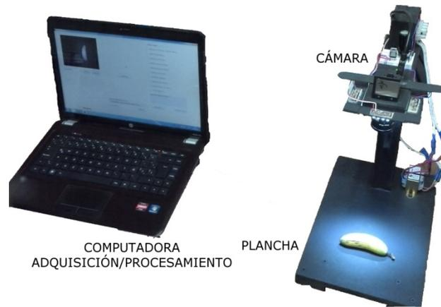
**Fig. 2. Sistema de adquisición y procesamiento de MSI.**
