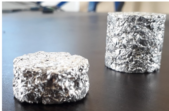
Figura 5 Probetas de aluminio plegado previo y posterior a los ensayos.
