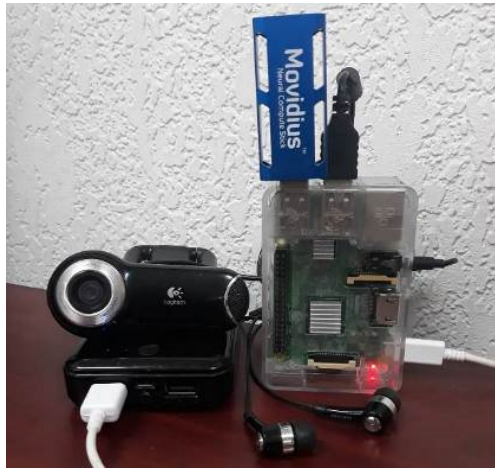
Figura 3 Prototipo funcional para clasificación de objetos en imágenes con salida de audio en un sistema embebido con red neuronal convolucional.
