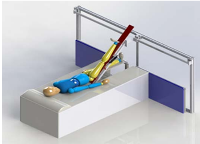
Figura 1 Rehabilitador de cadera de 3 gdl con guías lineales como actuadores.
