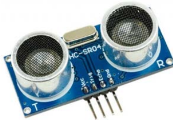
Figura 4 Sensor Ultrasónico HC-SR04.
