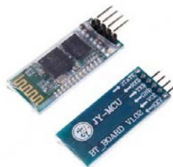
Figura 6 Modulo Bluetooth HC-06.
