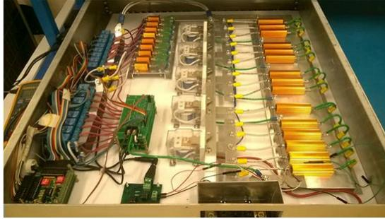
Figura 6 Módulo de control de cargas resistivas.
