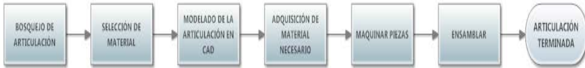
Figura 8. Pasos a seguir para manufactura de articulación.
