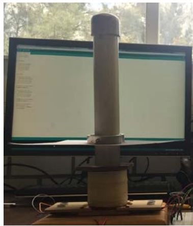
Figura 12 Anillo de Thomson levitando.
