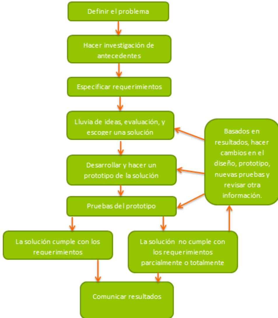
Figura 1. Proceso de diseño ingenieril.
