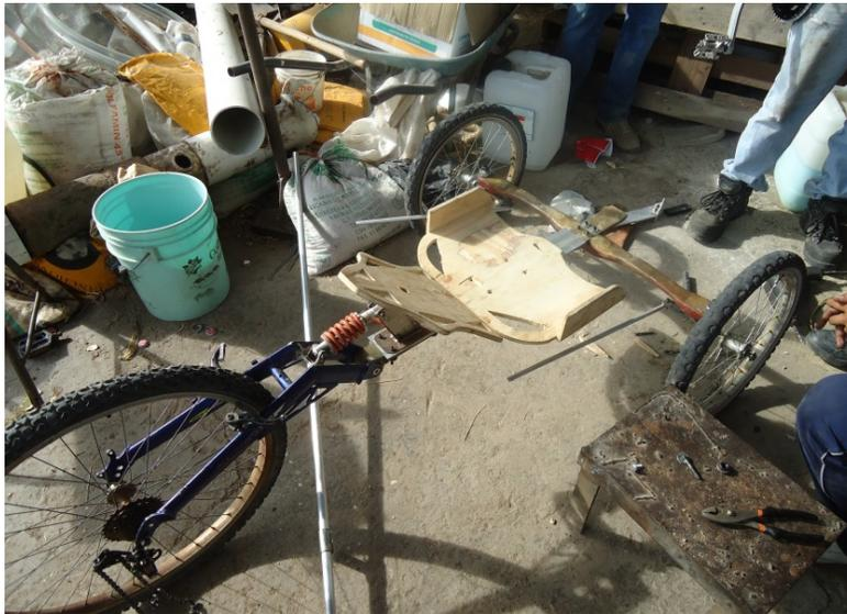
Figura 12. Posicionamiento del asiento móvil en el vehículo.
