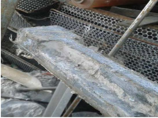
Figura 10. Eje con perfil en T, apenas desmoldado.
