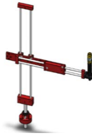
Figure 2 Brazo ergonómico diseñado en SolidWorks.
