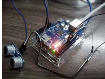
Figura 10 Conexión del sensor a la plataforma Arduino.
