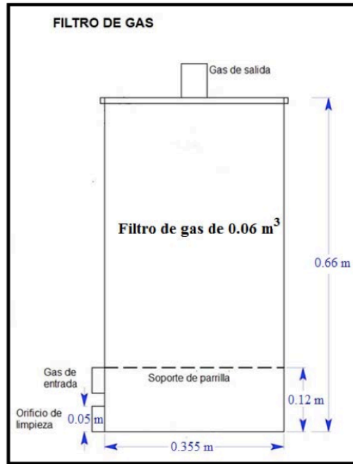
Figura 3 Diagrama y dimensiones del filtro de gas empacado.
