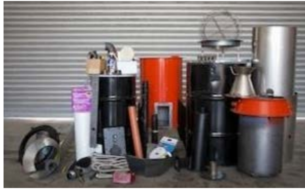
Figura 1 Fotografía de los componentes del gasificador de flujo descendente
