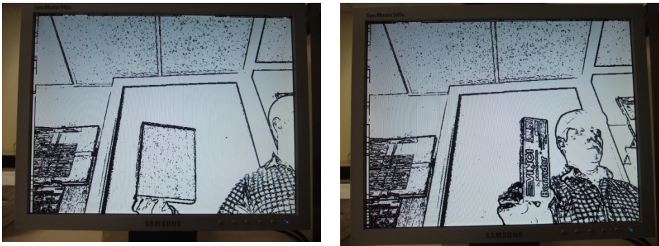
Fig. 10. Fotos de imágenes después de aplicar el filtro Sobel, izquierda de una caja y derecha de un borrador.
