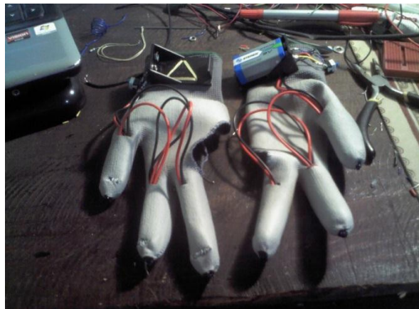
Figura 2 Construcción de los guantes con leds IR.
