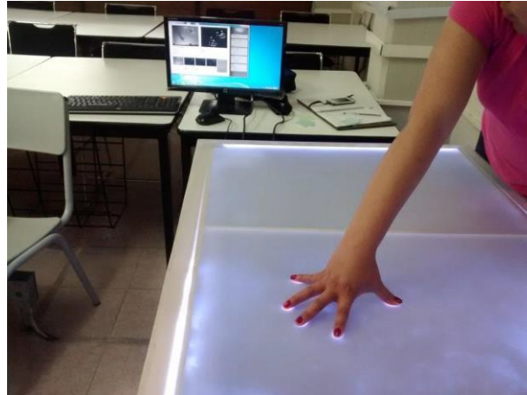
Figura 4 Prueba con el software CCV para visualizar el deslizamiento de los dedos.
