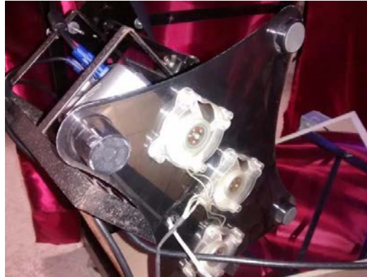
Figura 10 Sistema de Ventilación.
