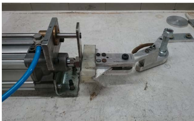
Figura 9 Prototipo neumático conceptual para el formado de solera.
