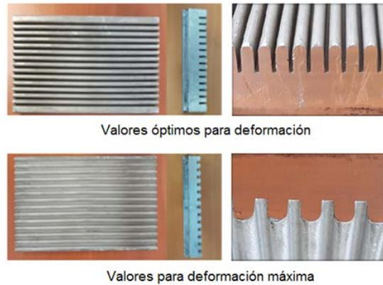
Figura 10 Insertos en aluminio fabricados por hilo-electroerosión.
