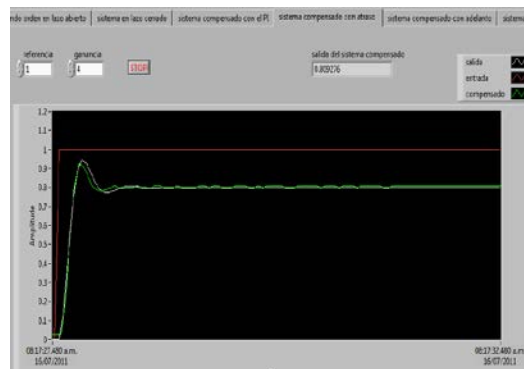
Figura 17. Respuesta transitoria compensador atraso.
