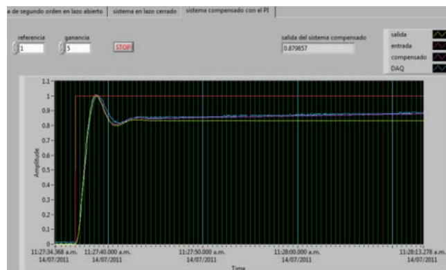
Figura 8. Respuesta transitoria compensador PI.
