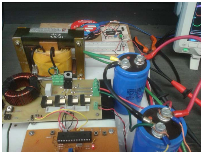
Figura 6 Prototipo del convertidor CA-CD bidireccional.
