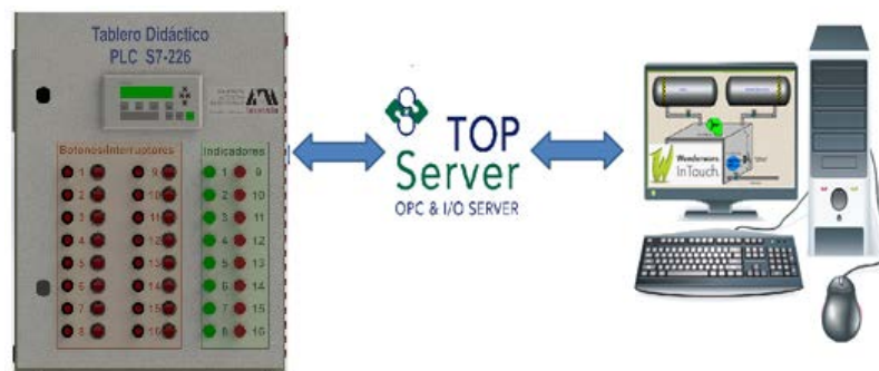
Figura 7 Intercambio de información utilizando TOP SERVER.
