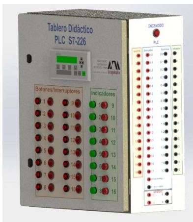
Figura 1 Tablero didáctico para practicas con PLC'S.
