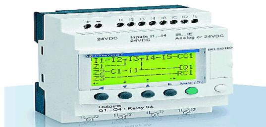
Figura 3 Relevador Zelio marca Schneider modelo SR3B101FU.
