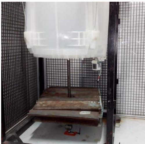
Figura 2 Banco de pruebas para medir deflexiones en el fondo de la tina.
