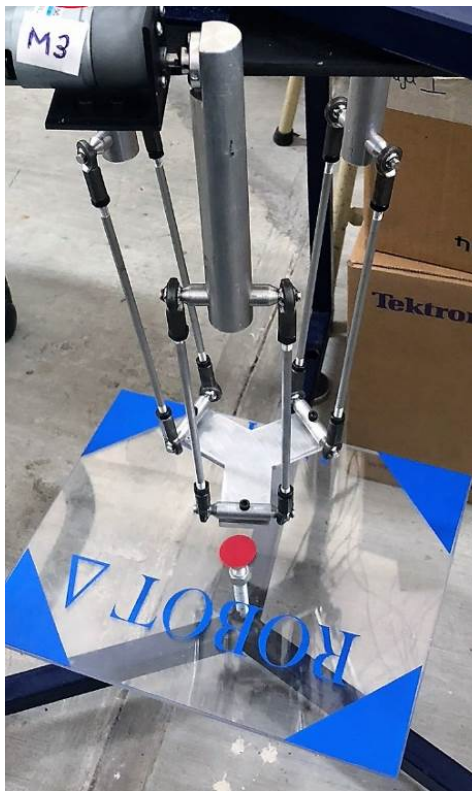
Figura 8 Robot Delta ensamble final.
