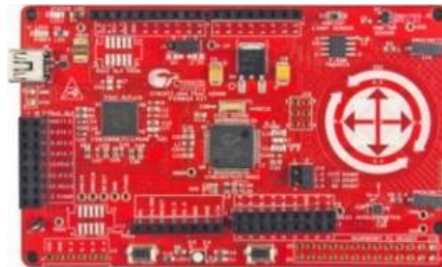
Figura 11 Microcontrolador PSOC 4 utilizado en el prototipo.
