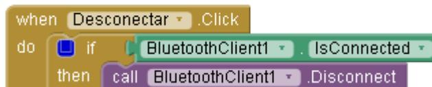
Fig. 9. Cierre de conexión.
