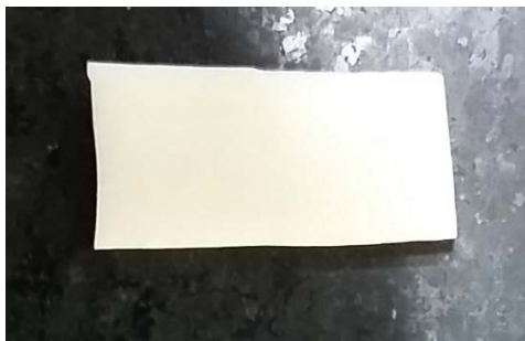
Figura 3 Probeta de hueso cortical preparada para el ensayo de dureza.
