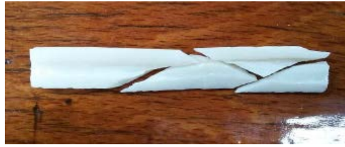
Figura 9 Probeta ensayada bajo cargas de torsión.
