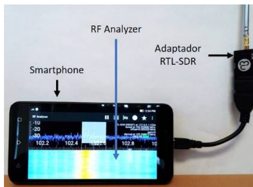
Figura 5 Analizador de bajo costo considerando un smartphone.
