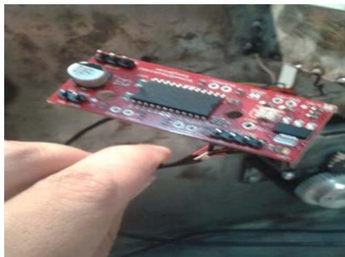
**Fig. 9. Control del prototipo, Arduino Leonardo y driver.**
