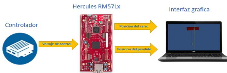
Figura 3 Entradas y salidas del simulador HIL.
