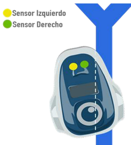
Fig. 7. Ambos sensores de línea sensando blanco.
