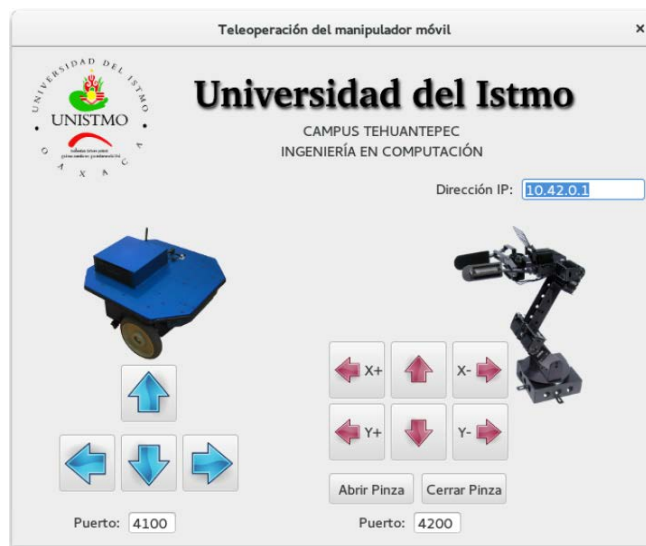
Figura 7 Interfaz gráfica para el control del manipulador móvil.
