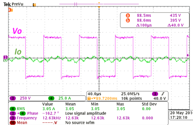
Figura 14 Formas de onda del Inversor Resonante con P_o = 938 W.
