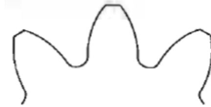
Figura 2 Dientes con perfil de involuta.
