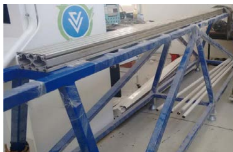
Figura 10 Montaje del perfil IPS en la estructura de la base.
