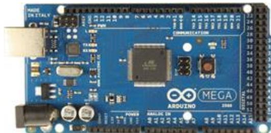
**Figura 8. Módulo Arduino Mega.**
